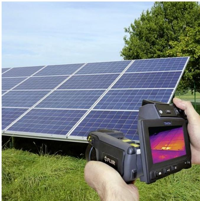
Auch Photovoltaikanlagen brauchen hin und wieder Pflege. Denn die Leistung einer Anlage kann durch Verunreinigungen oder technische Schäden mit der Zeit deutlich nachlassen. Die EWB hilft Besitzern einer Photovoltaikanlage beim Aufspüren von möglichen Schwachstellen, die die Rendite schmälern – und zwar mit einer Infrarotkamera.
